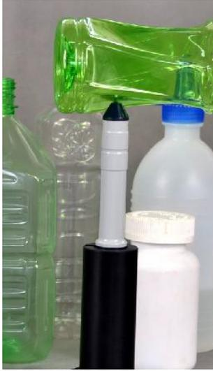
El ekumet MU opera en base a la teoría del efecto “Hall ” a donde se apoya una bolilla de acero de un lado de la pieza que queremos medir, mientras que del lado opuesto se apoya la sonda. La sonda de efecto Hall mide la distancia desde la punta de la sonda a la bolilla de acero con extrema precision.
